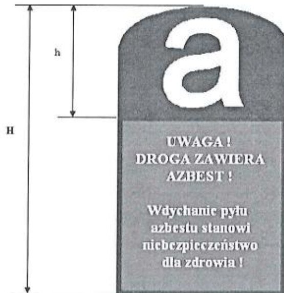
Rys. 4. Wzór oznakowania dróg utwardzonych odpadami zawierającymi azbest
